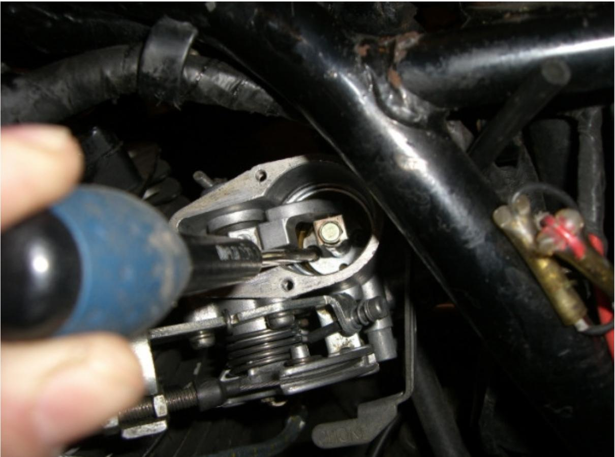
Basculer l'axe de levée et retirer l'aiguille..
