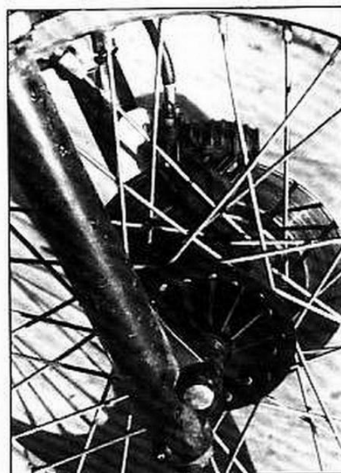
Le nouveau moyeu nécessite un rayonnage de la jante. Une prise de câble compteur est prévue du côté droit.
