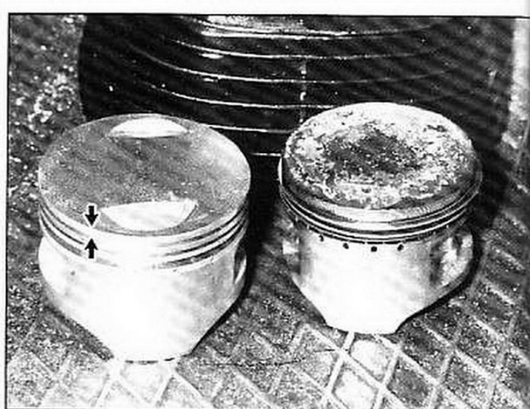
Le piston J.P.X. à gauche et celui d'origine à droite. Ils sont de hauteur identique mais la gorge du segment raclleur sur le J.P.X. est plus haute, ce qui a amené à décaler vers le haut les gorges des deux autres segments. La distance séparant la calotte du piston de la gorge du segment de feu (flèche) est donc plus faible.
