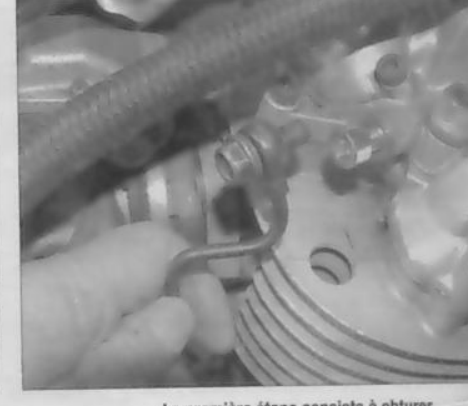
La première étape consiste à obturer l'orifice latéral d'entrée d'huile.
