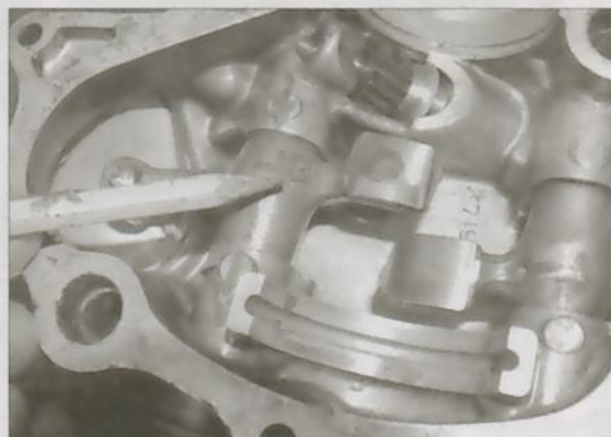
Sur d'autres versions, l'orifice est situé au milieu du patin.
